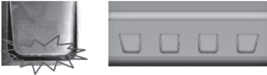
図6 コーナー R 部分の割れと変更点
