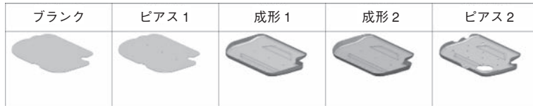
図3 マグネシウム合金エンジンカバー、工程ごとの製品図
